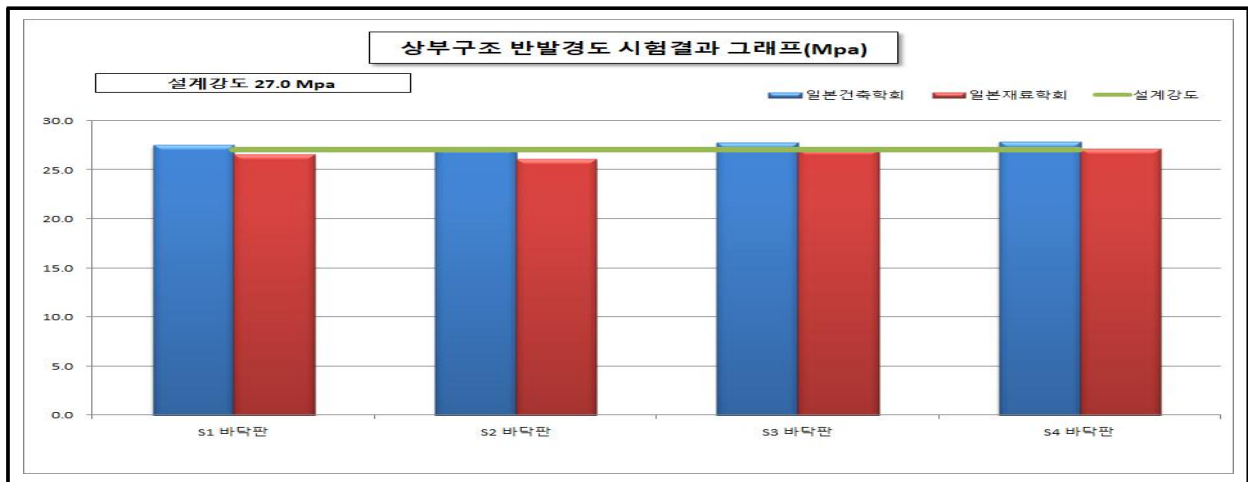
【그림 42.4.2】 상부구조 반발경도시험 측정결과
